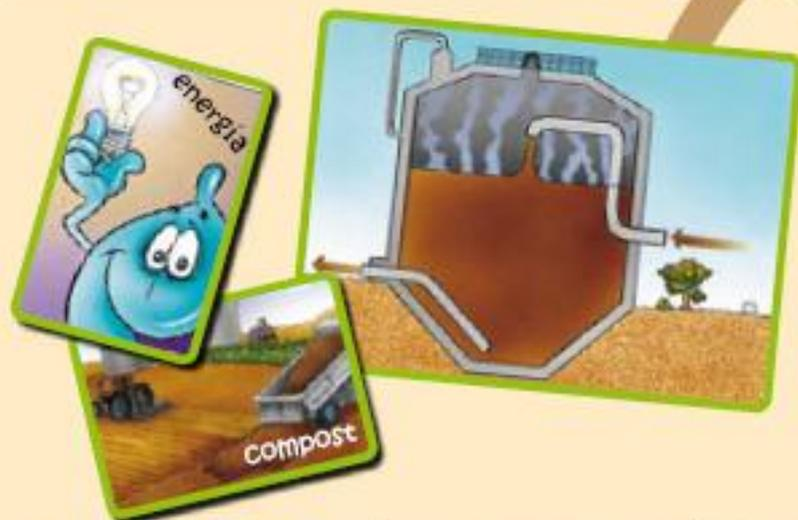
El **fango** se mete en un estómago gigante llamado **digestor**. Aquí fermenta y se transforma en **fango digerido**.
